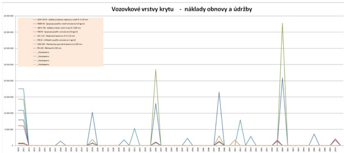
Obr. 5: Celkové náklady životního cyklu (LCC) konstrukčních vrstev vozovky [5]
